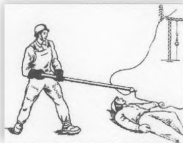
Мал. 2. Звільнення потерпілого від дії струму в електроустановках напругою понад 1000 В ізолюючою штангою
